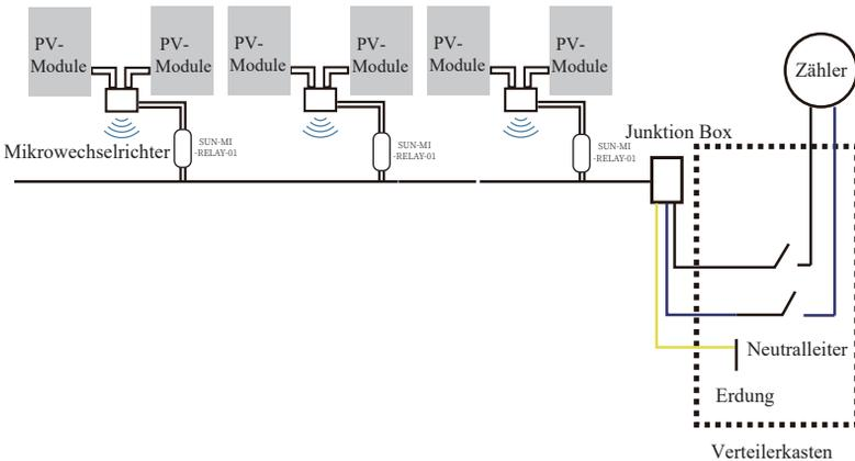
**ACHTUNG:** Der Farbcode der Verdrahtung kann je nach den örtlichen Vorschriften unterschiedlich sein; überprüfen Sie alle Drähte der Anlage vor dem Anschluss an das AC-Kabel, um sicherzustellen, dass sie übereinstimmen. Eine falsche Verkabelung kann zu irreparablen Schäden an den Mikrowechselrichtern führen, die nicht von der Garantie abgedeckt sind.
