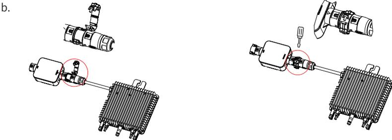
**HINWEIS:** Für die Verbindung zwischen SUN-MI-Relay-01 (Netz- und Anlageschutzgerät) und Mikro-Wechselrichter wird das Werkzeug (Schraubendreher) benötigt.
