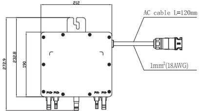
Das AC-Kabel am Mikro-Wechselrichter ist ein TC-ER-Kabel mit einem Kabelquerschnitt von 1 mm<sup>2</sup>(18AWG).
