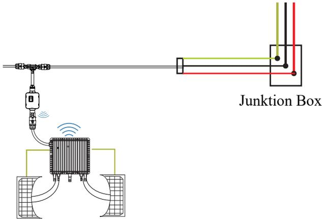
Schritt 5 - Anschließen des Microinverters an die PV-Module
